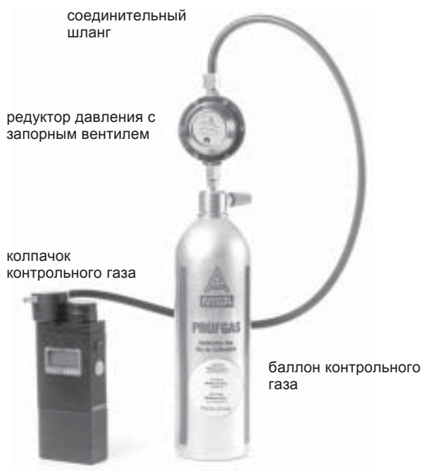
Рис.: Юстировка (калибровка) EX-OX-METER II (P)
