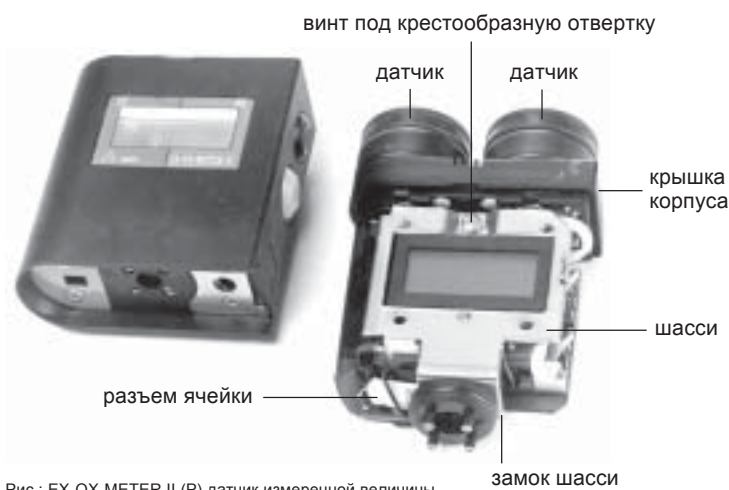
Рис.: EX-OX-METER II (P) датчик измеренной величины
